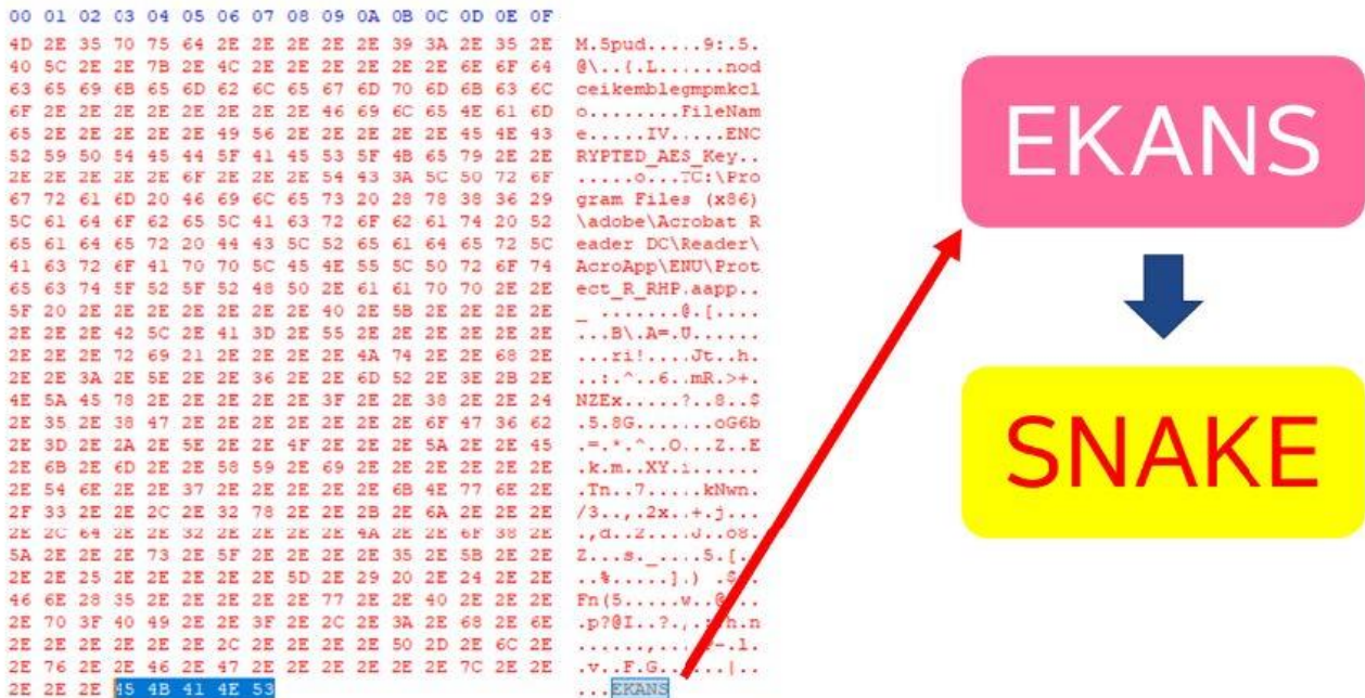
【图 3】针对工控系统的Snake勒索软件
